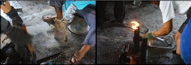
เนื้อโลหะผสมที่หลอมแล้วนำมาเทใส่แบบสี่เหลี่ยมให้เป็นแผ่นก่อนนำมารีดเพื่อป้อนเหรียญครับ
